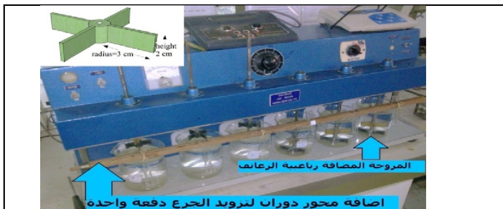
(3) صورة جهاز الجرة وبعض التعديلات التشغيلية وابعاد المروحة المضافة الرباعية الرفات لعملية التليد المثقل
